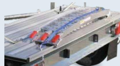
Klappbare Auffahrrampe. Bis 340 kg belastbar.
