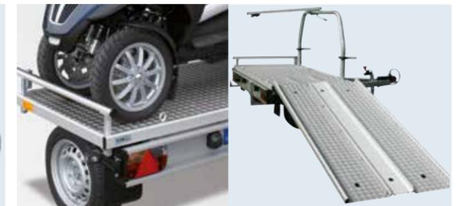
Rüstsatz Dreiradroller mit 3-teiliger Auffahrschiene
