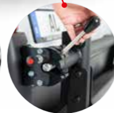
Einfach und gefahrlos entriegeln und schwenken. Verriegelung rastet automatisch ein
